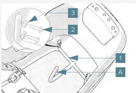
Positioneer het adapterframe **1** met de opstaande buis **A** zoals aangegeven in de afbeelding.
