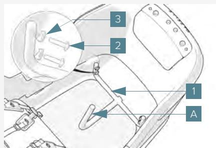
Positionieren Sie den Adapterrahmen 1 mit dem aufgerichteten Rohr A wie in der Abbildung dargestellt.
