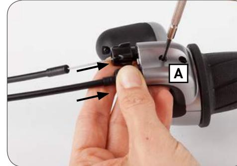
**6.** Drehen Sie die Griffrolle, um den nächsten Seilzug einzufädeln und wiederholen Sie Schritt **4.** und **5.**
