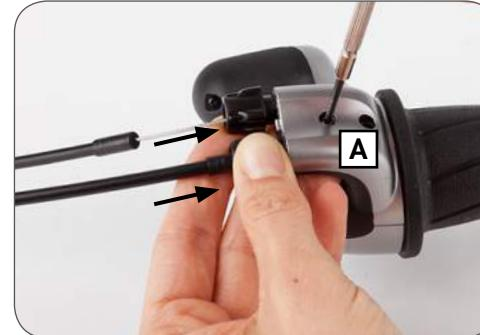
**6.** Faites tourner la poignée afin de la placer dans la position adéquate pour installer le câble suivant et répétez les étapes 4) et 5).
