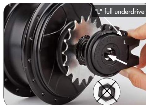
**8.** Draai de CVP met de klok mee door deze aan het tandwiel te draaien **(A)**, terwijl de Nfinity naafinterface **(B)** tegen de klok in draait tot de full overdrive "H" positie totdat een duidelijke stop gevoeld wordt. Herhaal dit proces 2 tot 3 keer door de CVP met de klok mee te draaien en tegelijkertijd de Nfinity naafinterface heen en terug te draaien, eindigend met een volledige stop richting (maar waarschijnlijk niet op) de full drive "H" positie.
